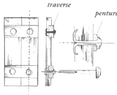
Les pentures permettent d'assembler les planches et créer un décor.
